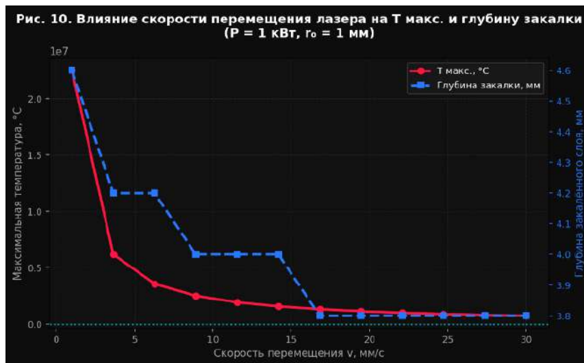
Рисунок 3. Зависимость максимальной температуры и глубины закалённого слоя от скорости перемещения лазера v . Показывает критическую скорость ( \sim 12 мм/с), при превышении которой температура не достигает порога аустенизации.
