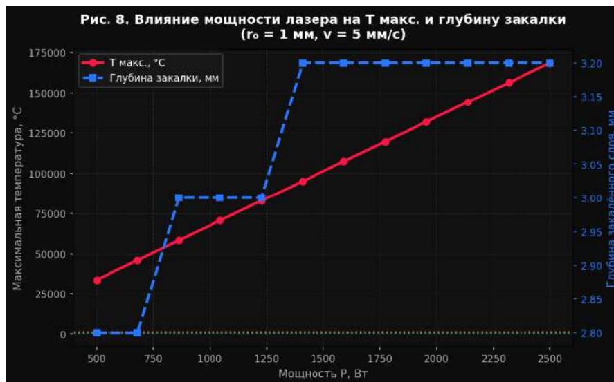
Рисунок 1. Зависимость максимальной температуры (красная кривая, левая ось) и глубины закалённого слоя (синяя кривая, правая ось) от мощности лазера P в диапазоне 500–2500 Вт. Пунктирные линии — пороги аустенизации и плавления.
