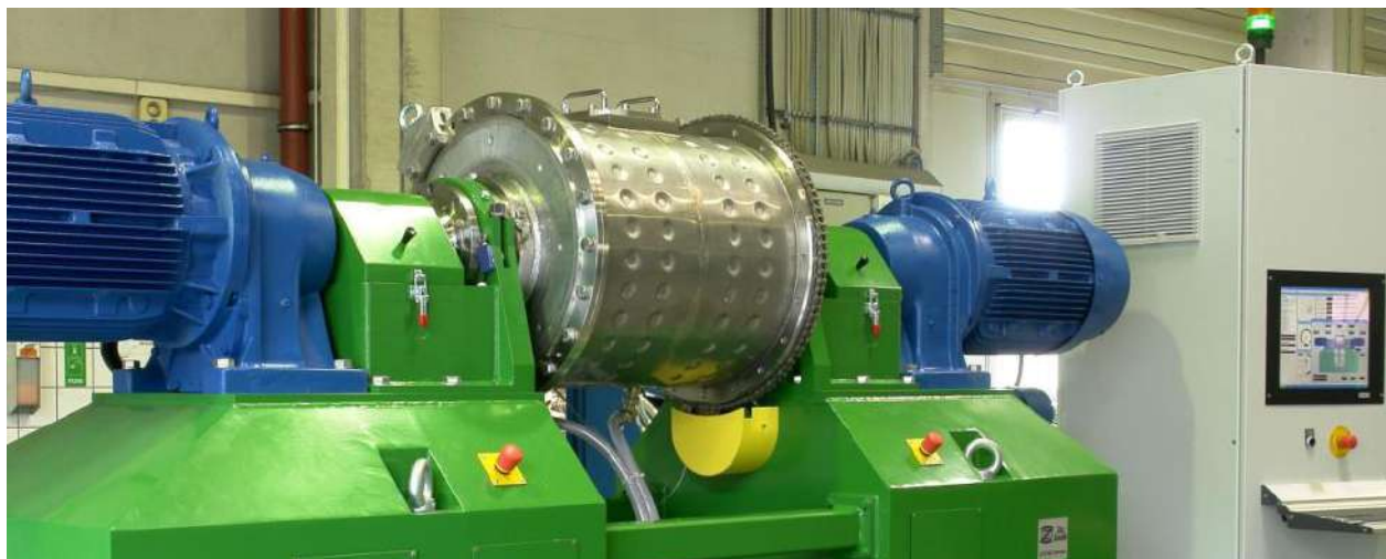
Рис.1. Мельница фирмы Цоц: Simoloyer® CM100
