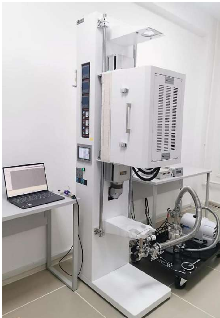
Рисунок 1. Экспериментальная установка по выращиванию кристаллов методом Бриджмана в аргоновой атмосфере после создания высокого технического вакуума ( 10^{-6} Торр).
