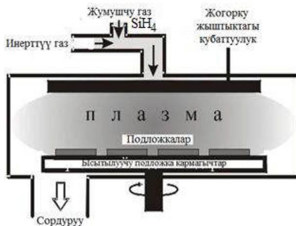
4 - сүрөт. Разрядды эки электроддуу сыйымдуулук системасы менен кармап
