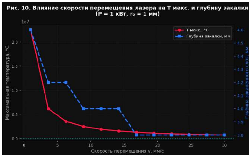
Рисунок 3. Зависимость максимальной температуры и глубины закаливаемого слоя от скорости перемещения лазера v . Показывает критическую скорость ( \sim 12 \text{ мм/с} ), при превышении которой температура не достигает порога аустенизации.
