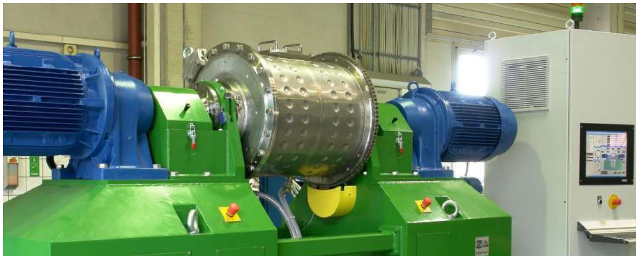
Рис.1. Мельница фирмы Цоц: Simoloyer® CM100
