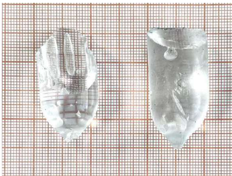
Рисунок 2. Кристаллы KCl:Li, выращенные по методу Бриджмана в статическом режиме вакуумирования ( 10^{-6} Торр) реактора с последующим созданием аргонной среды (1.1-1.3 бар) по заданной через НМІ циклограмме.
