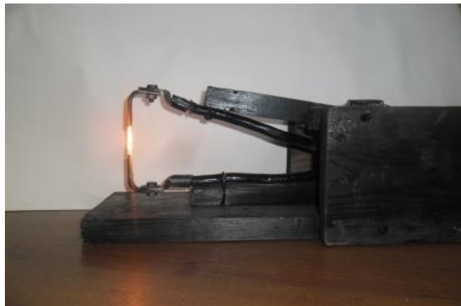
4-сүрөт. Ширетүүчү түзүлүшүн жаркырактык температурасын баалоо
